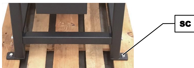
Рис. 3: Крепление на транспортировочном поддоне
