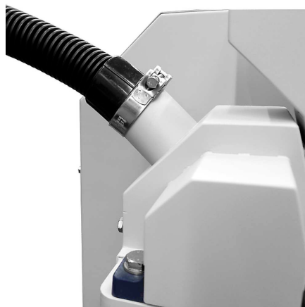
Przyłącze do odciągu pyłu
