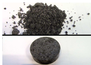
炉渣 40 克 粒径 0.25 毫米 压制工具 40 毫米
