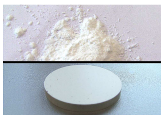
纤维素 7 克 粒径 0.15 毫米 压制工具 40 毫米
