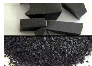
タイヤ（ゴム） ドライアイス、液体窒素を 使った凍結粉碎方法
