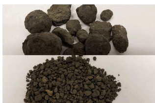
clinker de ciment
