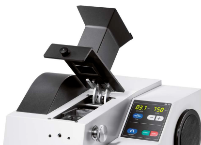
La trémie repliable peut être retirée pour un accès facile
