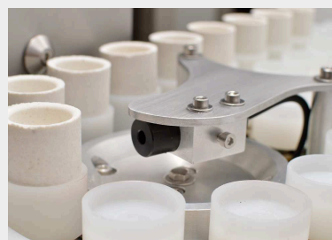
Autocarregador com suportes de cadinhos de plástico resistentes a ácidos
