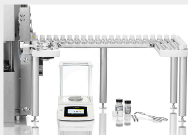
Autoloader cu 130 de poziții pentru creuzete
