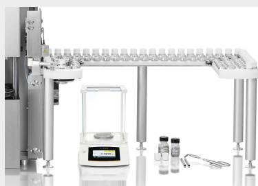
Autoloader cu 130 de poziții pentru creuzete
