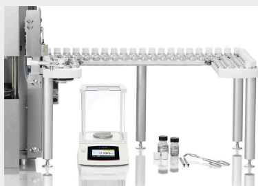
Autoloader con 130 posiciones para crisoles
