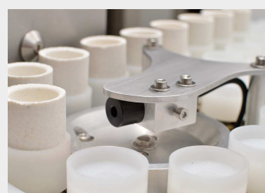
Chargeur automatique avec supports de creuset en plastique résistant à l'acide
