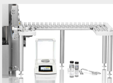
Chargeur automatique comprenant 130 positions de creuset
