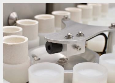
Autoloader mit Tiegelträgern aus säureresistentem Kunststoff
