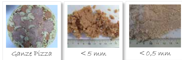
Abb. 1: Von links nach rechts: komplette Pizza; Vorzerkleinerung auf <5 mm; Endfeinheit <0,5 mm
