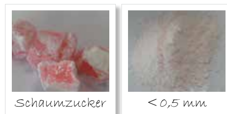
Abb. 10: Homogenisierung von Schaumzucker; links: Ausgangsprobe; rechts: Endfeinheit <500 µm
