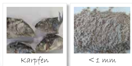
Abb. 6: Homogenisierung von Fisch; links: Ausgangsprobe; rechts: Endfeinheit <1 mm
