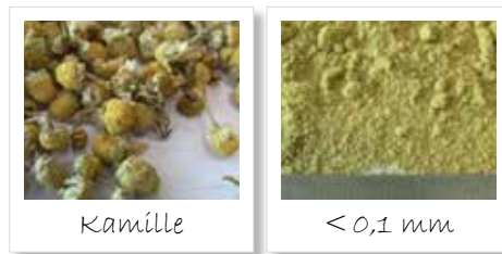
Abb. 7: Homogenisierung von Kamille; links: Ausgangsprobe; rechts: Endfeinheit <100 µm
