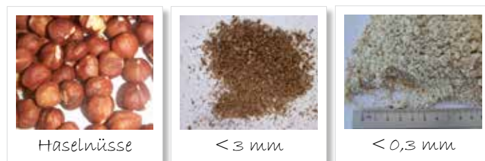
Abb. 5: Homogenisierung von Nüssen; von links nach rechts: Ausgangsprobe; Vorzerkleinerung auf <3 mm; Endfeinheit <300 µm
