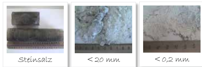
Abb. 9: Homogenisierung von Steinsalz; von links nach rechts: Ausgangsprobe; Vorzerkleinerung auf <20 mm; Endfeinheit <200 µm
