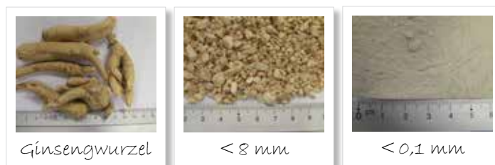
Abb. 8: Homogenisierung von Ginseng; von links nach rechts: Ausgangsprobe; Vorzerkleinerung auf <8 mm; Endfeinheit <100 µm
