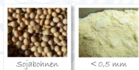
Abb. 11: Homogenisierung von Sojabohnen; links: Ausgangsprobe; rechts: Endfeinheit <500 µm
