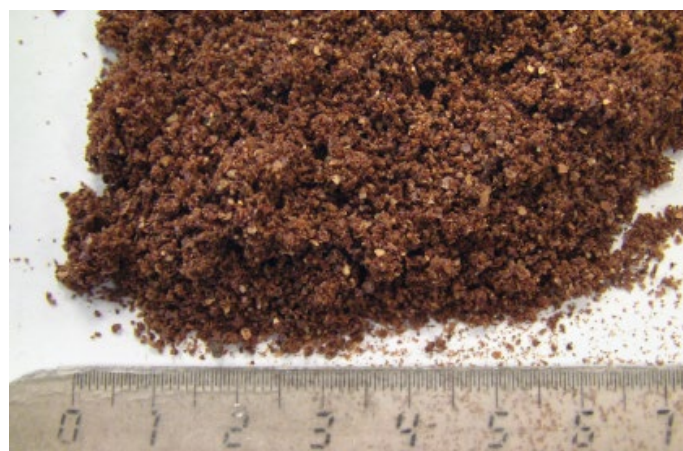
Abb. 3b: Kakaobohnen nach der Vermahlung in der Rotormühle ZM 200
